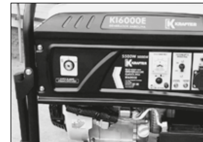
Interruptor basculante para generador (posición OFF).
